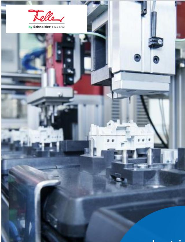
Kraft-Weg Überwachung der Schaltwippe sowie Schalterfunktionalität
