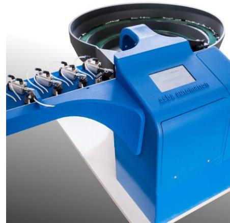
Wendelförderer, Gehäuse, Sensorhalterungen sowie diverse Sortierelemente aus PA-HF (Polyamid12 hochfest). Die Vorteile die Aerne engineering AG überzeugt haben waren: schnelle Verfügbarkeit, gute Verschleisswerte und Design-Freiheit.
