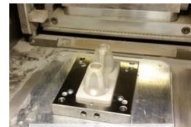
additiv gefertigt (SLM) 20
