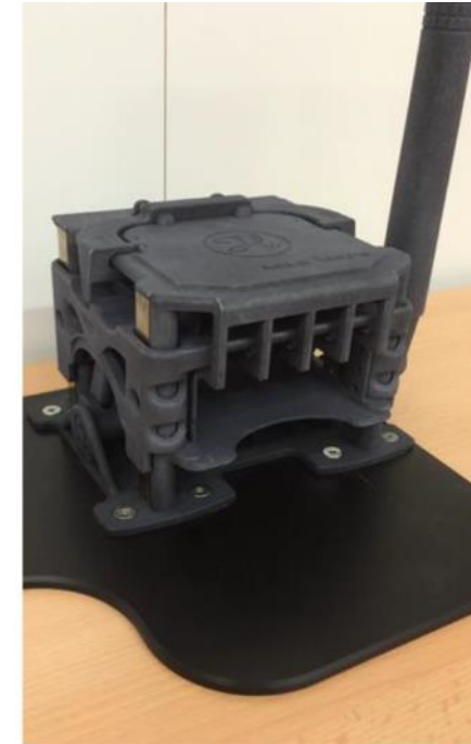
6-teilige Baugruppe «TubeLifter» montagefrei gefertigt. Magnete, Blattfedern und Aluminiumplatte nachträglich montiert
